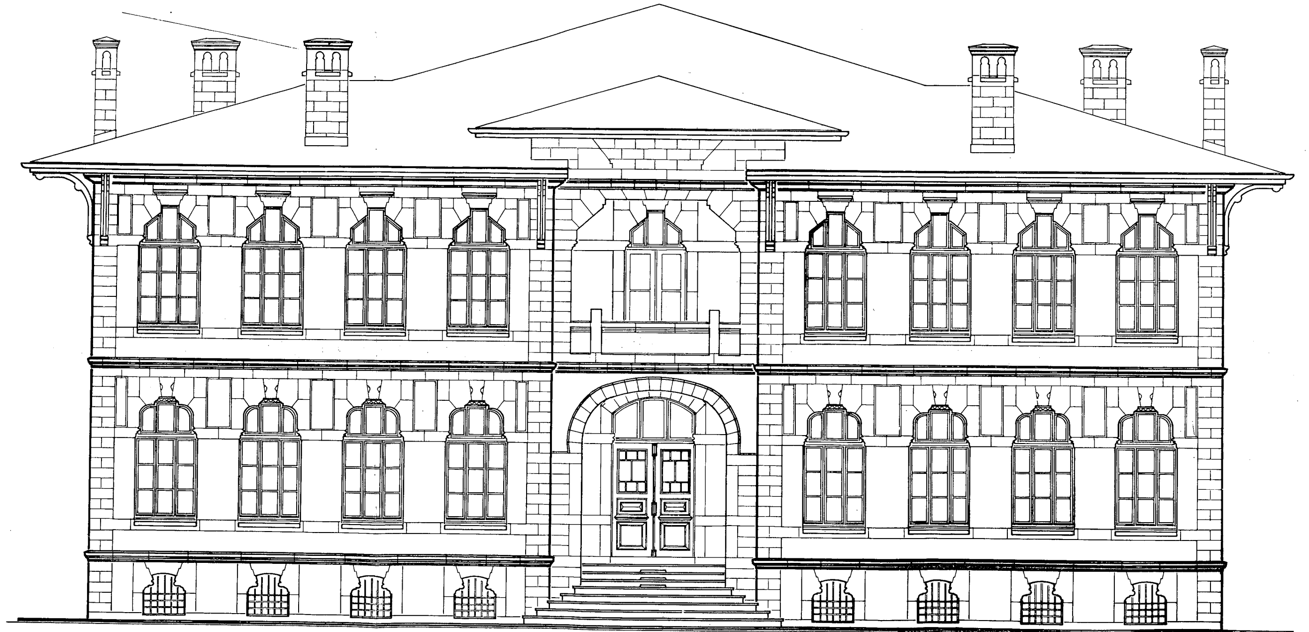
Şekil 21. Doğu Cephesi (ölçüler 11 Temmuz 1976 yangınından sonra alınması dolayısıyla saçakların gerçek durumu bilinmemiş, arşiv resimlerinin geç bulunması nedeniyle de saçaklar gerçekten 20 cm. kısa ve düşük kotta gösterilmiştir. Zaman darlığı nedeniyle düzeltme olanakı bulunamamıştır.)
